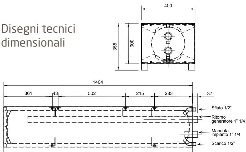
Il serbatoio inerziale compatto, disegnato per essere accoppiato alla pompa di calore Auriga, permette di risparmiare spazio rispetto all'installazione del classico puffer cilindrico. La capacità di 60 litri soddisfa il contenuto minimo d'acqua per tutti i modelli Auriga.
